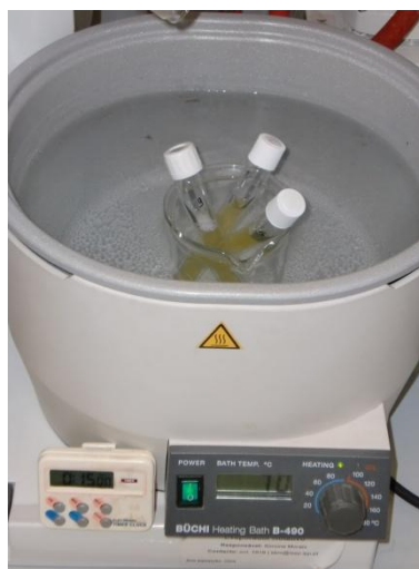
Figura 11: Aquecimento da amostra para a desconjugação de metabolitos
