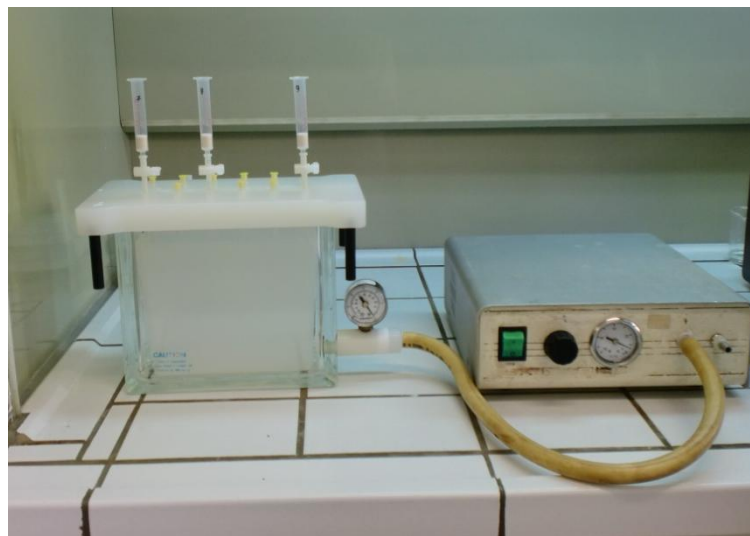
Figura 12: Sistema de SPE utilizado com cartuchos Strata X-C
