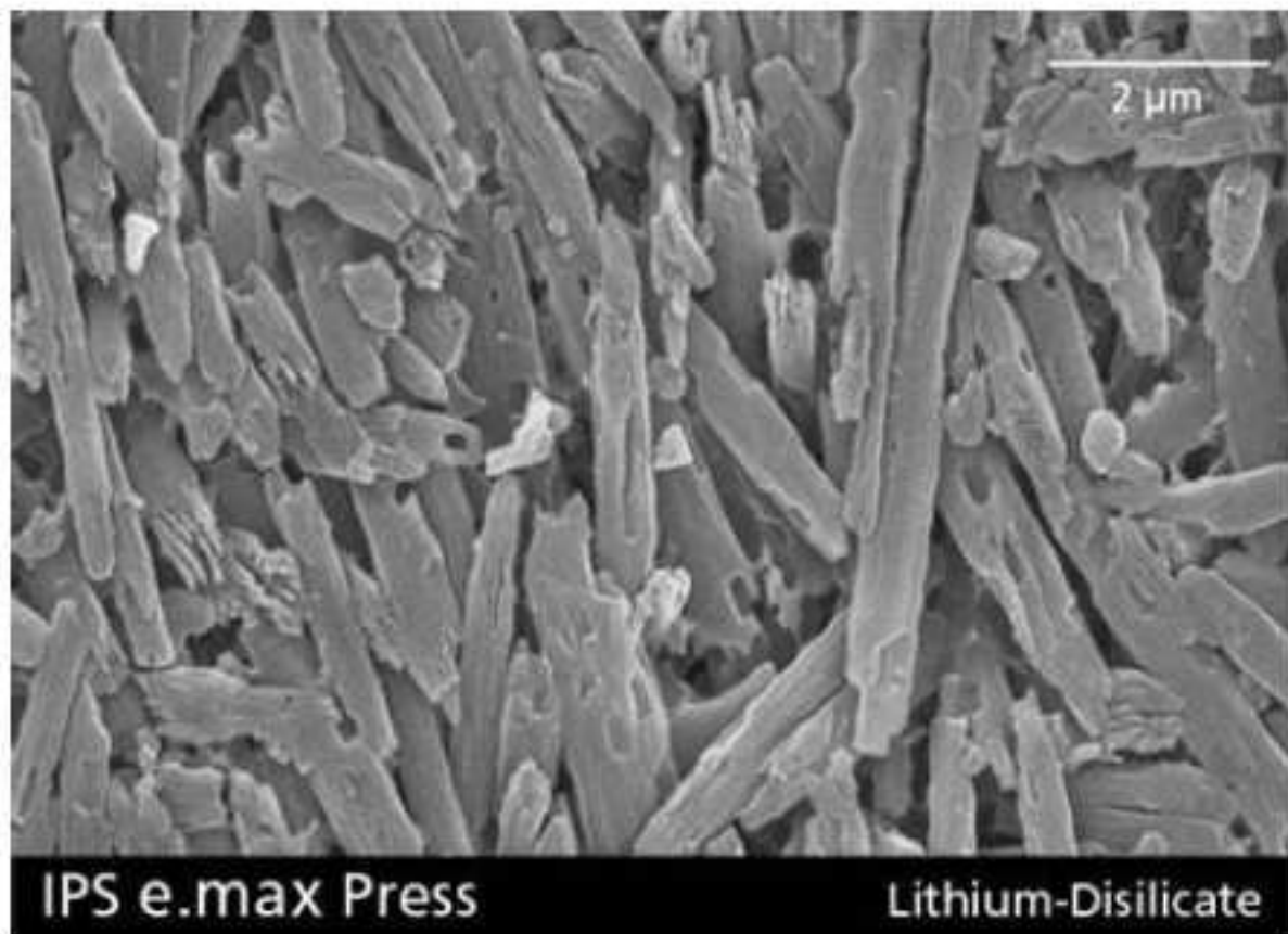
Figura 8: Microscopia electrónica (2mm) IPS e.max® Press de dissilicato de lítio [11]
