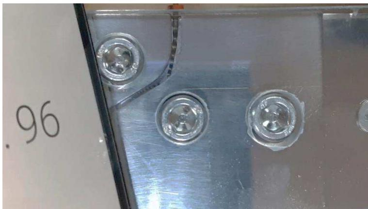
**Fig. 11-** Fratura do instrumento *WaveOne Gold®* (WOG #25/0.07, *Dentsply Maillefer®*, Ballaigues, Suíça) por fadiga cíclica.
