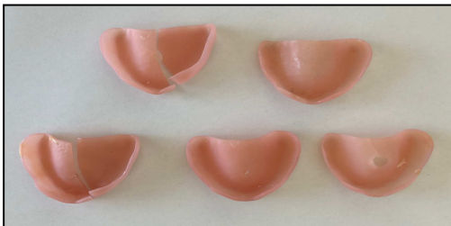
Figura 11. Bases de prótese "RS Vertex ® " submetidas a pH 7, após fratura
