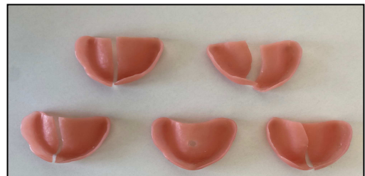
Figura 16. Bases de prótese "Megacryl®" submetidas a pH 4, após fratura
