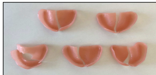
Figura 12. Bases de prótese "RS Vertex ® " submetidas a pH 4, após fratura
