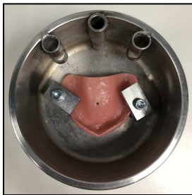
Figura 8. Base de prótese colocada para efetuar os testes de resistência ao impacto. Ponto marcado no centro do palato
