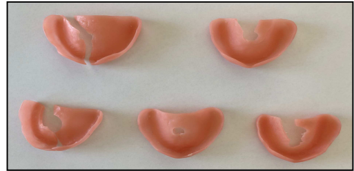
Figura 14. Bases de prótese "Triplex hot®" submetidas a pH 4, após fratura
