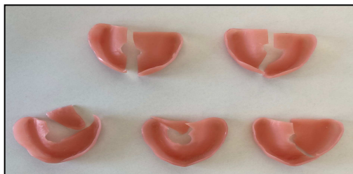
Figura 15. Bases de prótese "Megacryl®" submetidas a pH 7, após fratura
