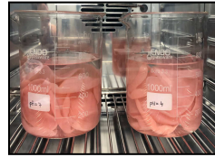
Figura 6. Bases de próteses submetidas aos dois diferentes valores de pH (4 e 7)
