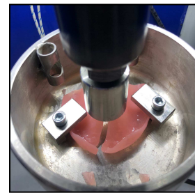
Figura 10. Fratura da base de prótese
