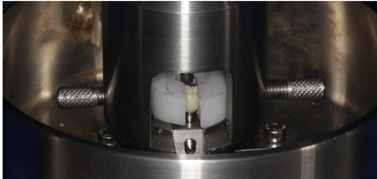
**Fig. 17:** Dispositivo de tração a envolver a coroa
