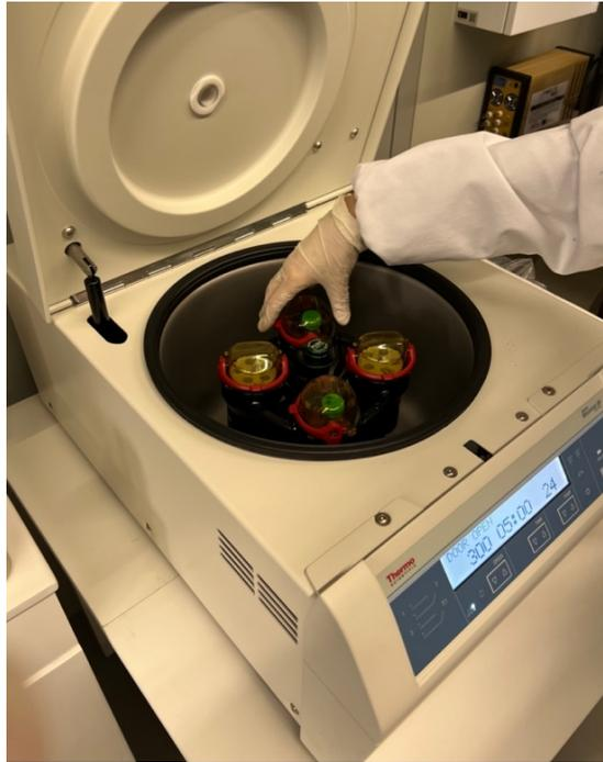
Figura 2- Colocação do *falcon* na centrífugadora.
