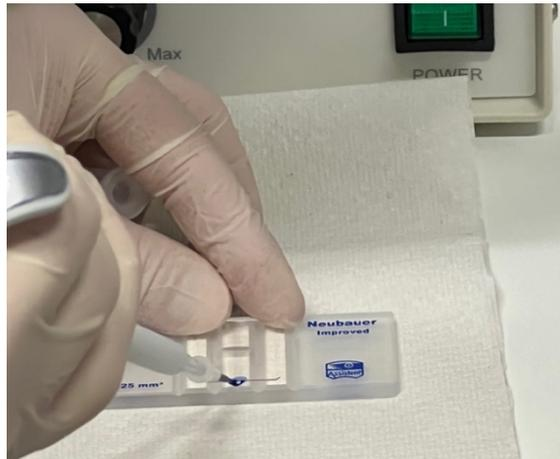
Figura 5 - Pipetagem de 10  $\mu$ L para a câmara de *Neubauer*
