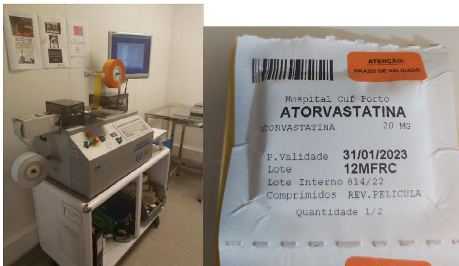
Figura 51. Equipamento de reembalagem e rotulagem de medicamentos e medicamento reembalado
