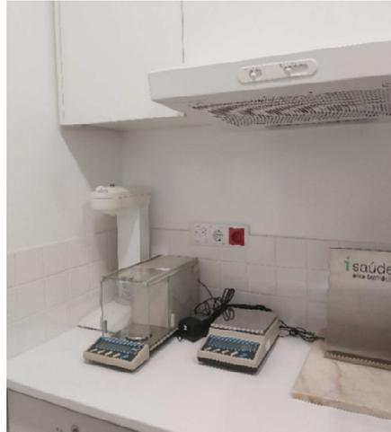
Figura 11. Laboratório – balança analítica, balança semi-analítica e exaustor
