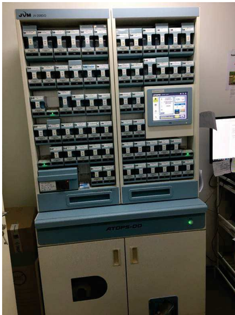
Figura 4: O robô distribuidor de medicamentos, o JUM JV-208DO
