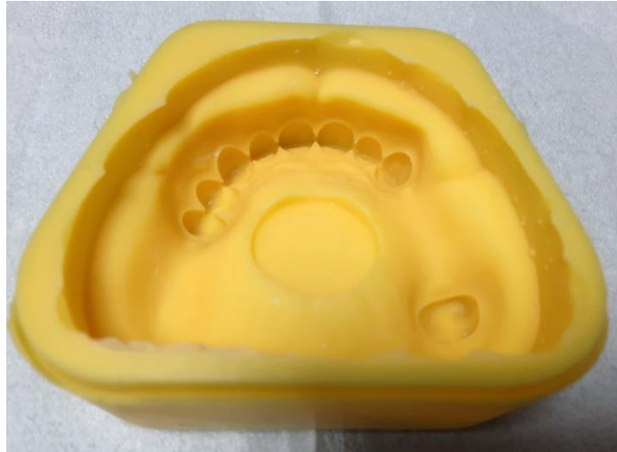
Fig. 2: molde de silicone para obter modelo original
