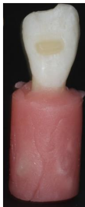
Figura 5 - Acrilização de dente incisivo inferior permanente bovino com a coroa e o respetivo attachment de 4milímetros.
