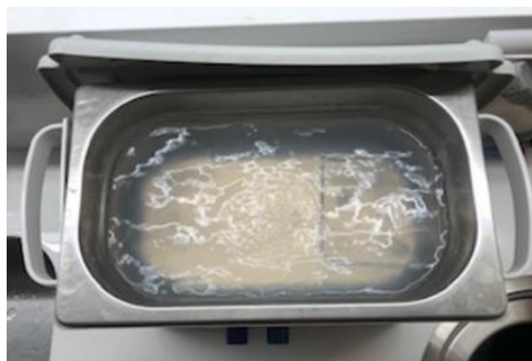
Figura 4 - Mini-implantes no processo de limpeza ultrassónica.
