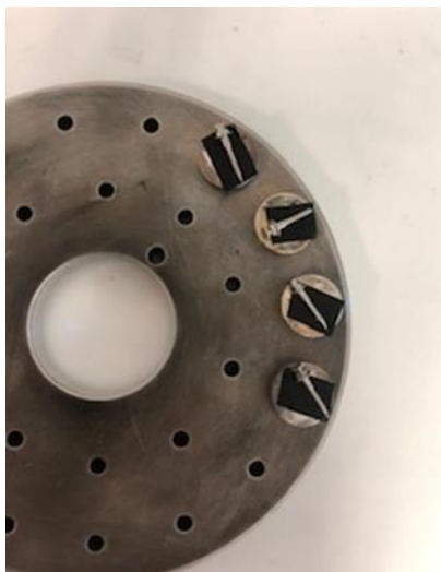
Figura 6- Mini-implantes no disco para visualização ao SEM (JSM-6010 LV, JEOL).
