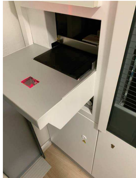
Figura 7. Tapete rolante de entrada dos medicamentos no robot
