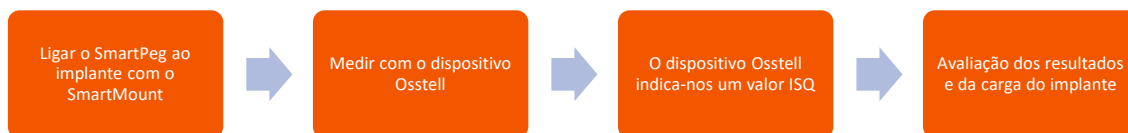
Figura 6: Procedimento de medição de ISQ Osstell. Fonte: Elaboração própria com base no procedimento da Osstell®.
