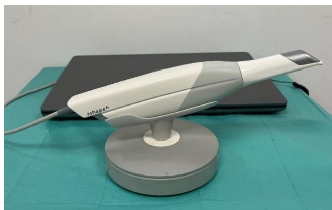
Figura 20 - Scanner intra-oral Trios 3 (3Shape®, Copenhaga, Dinamarca) e computador pessoal com configurações de hardware e software para digitalização
