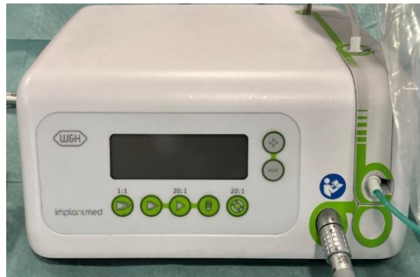
Figura 15 - Motor de implante dentário Implantmed W&H® (W&H Group, Bürmoos, Áustria) com regulação de rotações por minuto (rpm) e binário, acoplado com sistema de irrigação externa.
