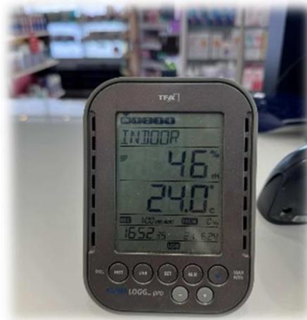
Figura 9. Termo-Higrómetro.
