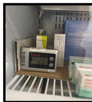
Figura 11: Termo-higrómetro digital no frigorífico
