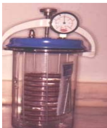
Fig. 10 Jarra Gaspak com ambiente anaeróbio para crescimento bacteriano
