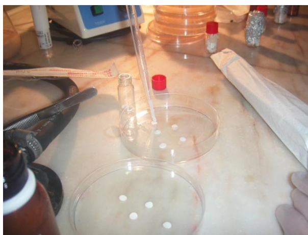
Fig. 3 – Discos de papel de filtro estéreis a serem embebidos nas substâncias a testar
