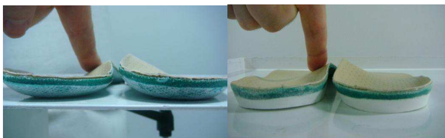
Figura 18 – Funcionalidade do estabilizador posterior plantar aquando da pressão sobre o arco medial
