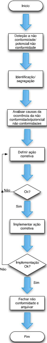
Figura 7 – Fluxograma do procedimento tratamento das não conformidades
