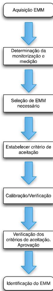
Figura 8 – Fluxograma do procedimento de calibração do Regulador de Pressão
