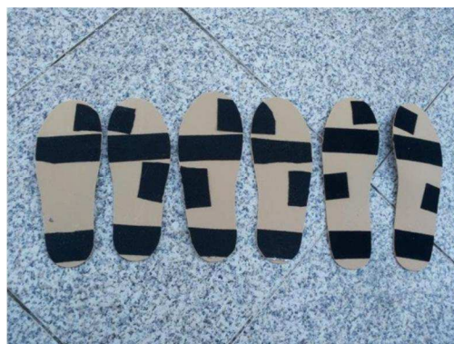
Figura 3 - Palmilhas em pelite com velcro para colocação de sensores
