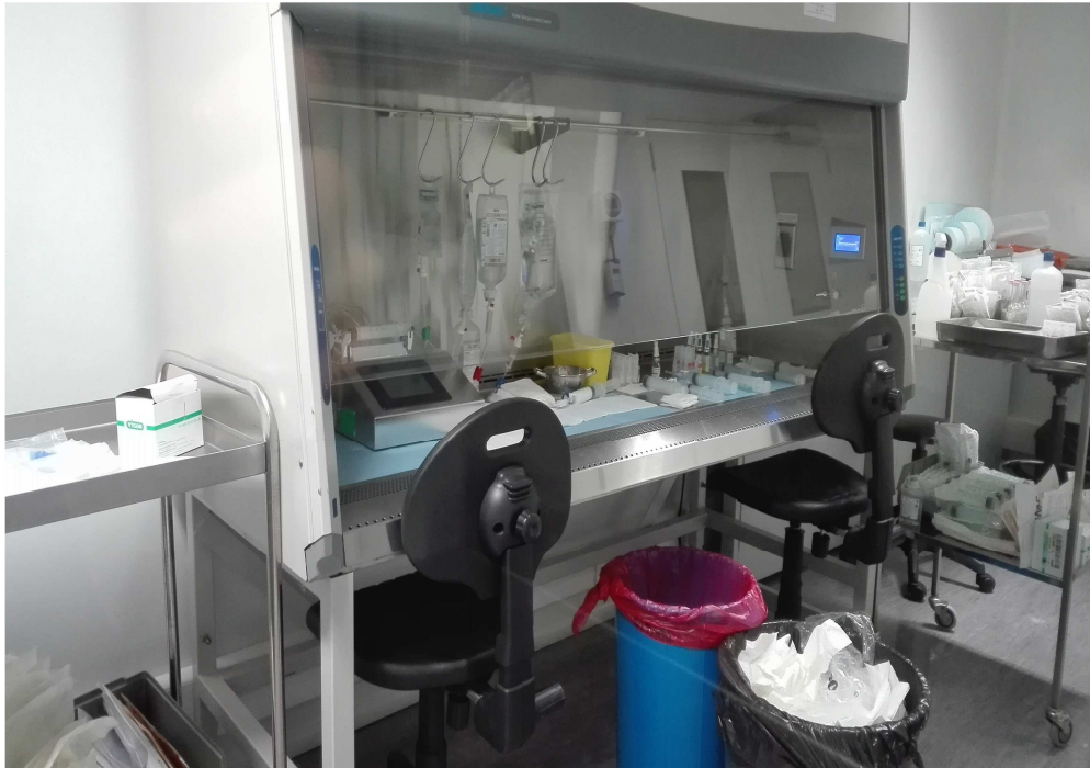
Figura 15 - Câmara de fluxo laminar vertical na unidade de preparação de estéreis (em funcionamento)
