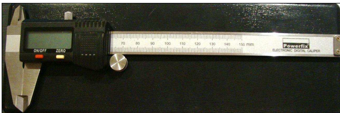
Figura 2 - Paquímetro digital (Digitaler Messschieber, Powerfix®)
