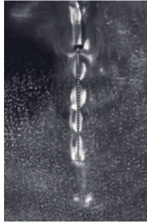
Figura 1 – Exemplo da vibração acústica, provocado por uma ponta de ultrassom numa solução irrigante. Adaptado de van der Sluis et al. (7)
