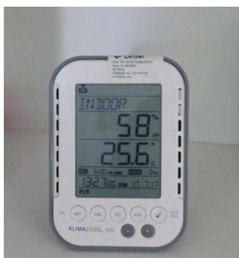
Fig. 14 - Termohigrómetro
