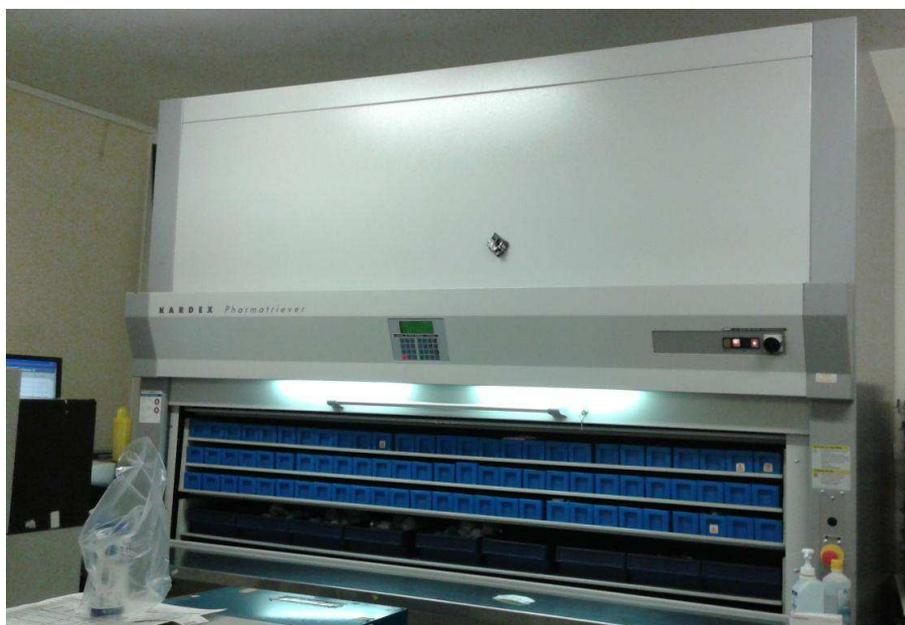
Fig. 5 – Sistema semiautomático de dispensa de medicamentos “Kardex”
