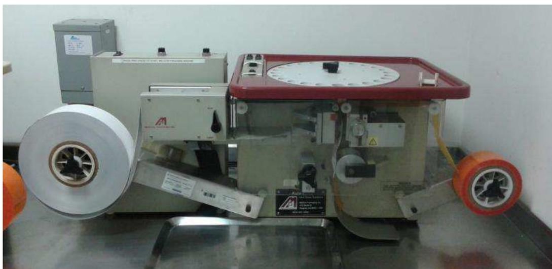
Fig. 15 – Máquina semiautomática de reembalagem
