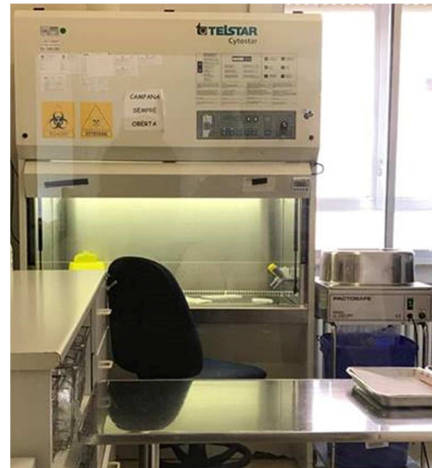
Figura 26. Câmara de fluxo laminar vertical existente na sala de preparação de citostáticos
