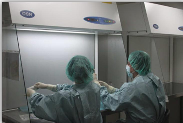
**Figura 11** – Sala Limpa, com duas CFAL horizontais
