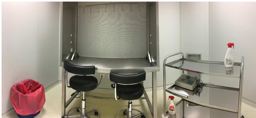
Figura 20: CFLH, utilizada para preparação de MN para NP.
