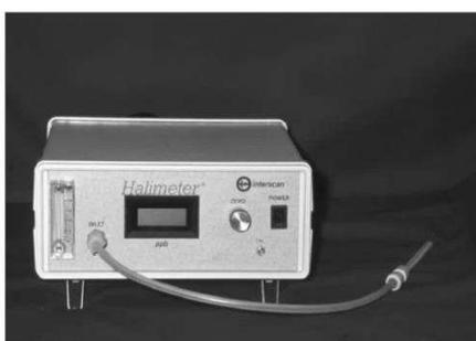
Figura 6- Halímetro: medida objetiva dos compostos sulfurados voláteis.
