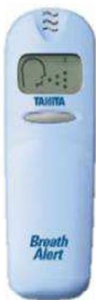
O medidor Halímetro (Breath Alerth<sup>®</sup>, TANITA, Japão) (Figura-9) é utilizado para a mensuração da halitose, com diferentes níveis de odor. É calibrado antes do uso, repetindo-se as medições feitas em um mesmo indivíduo três vezes consecutivas.<sup>(2,8,23)</sup>
