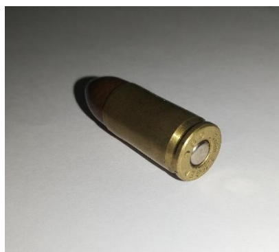
Figura 11 - Zona visível do fulminante, neste caso, numa munição de fogo central.
