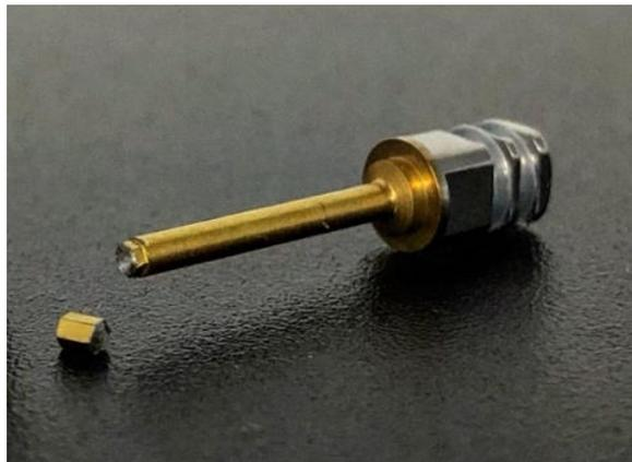
*Figura 47 - Pormenor do ponto de fratura das chaves protética Bti<sup>®</sup>.*
