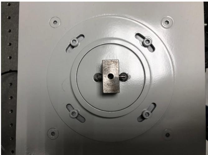
Figura 5 - - Célula de Carga (vista superior) com pormenor da zona de retenção das peças protéticas.
