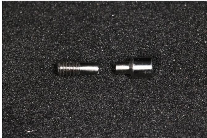
*Figura 49 - Representação do local de fratura dos parafusos estudados.*
