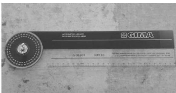
Figura 12 - Goniómetro flexible de dos brazos
