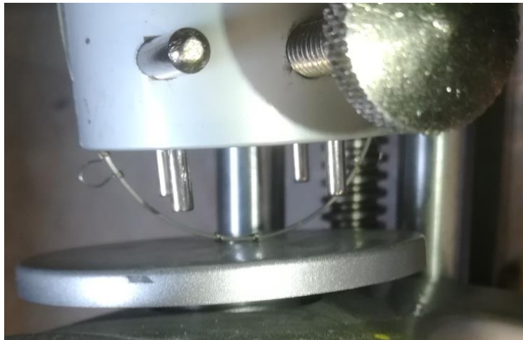
Figura 15: Teste de medição das molas na Balança.
