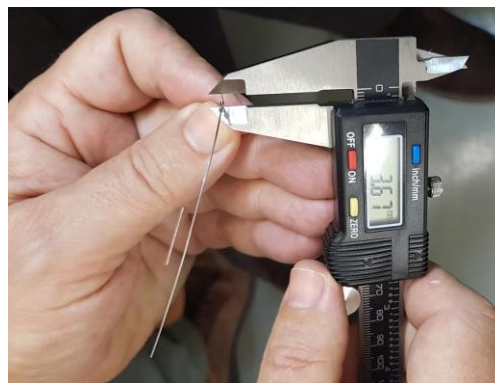
Figura 17: Medição da secção de recta de um dos arcos utilizados no ensaio com o paquímetro digital
