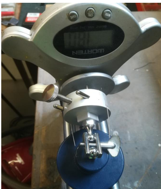
Figura 12: Balança durante a medição da força gerada pela mola (Worten® da serie B6182)
