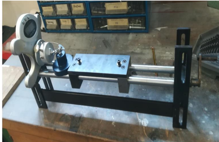
Figura 10: Dispositivo desenvolvido pela faculdade de Engenharia para aplicar um deslocamento sobre a mola de forma controlada e medir a força realizada por estar sobre uma balança
