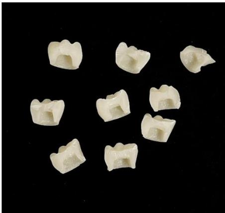
*Figura 18: Coroas em LuxaCrown após ensaio de resistência mecânica à compressão - destruição total da coroa.*
