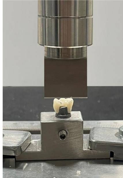
*Figura 16: Ponto de fratura das coroas em LuxaCrown*
