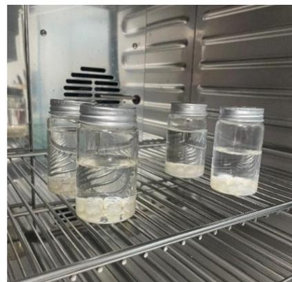
*Figura 10: Figura 11: Coroas de LuxaCrown e Protemp™ 4 submetidas a pH 4 e pH7*
