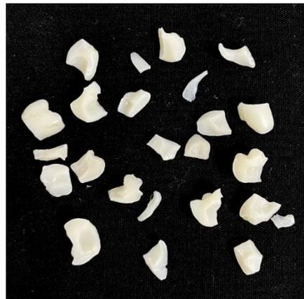
*Figura 17: Coroas em Protemp™ 4 após ensaio de resistência mecânica à compressão - destruição estilhaçada da coroa.*
