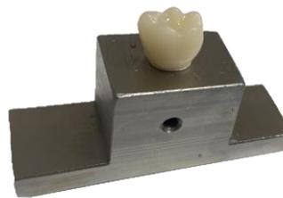
*Figura 7: Coroa em LuxaCrown incorporada no suporte metálico*
